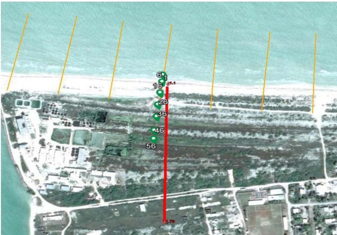
Figura 5. Transectos de Estudio en playa de Sisal. En amarillo se muestran perfiles de los cuales se tiene un estudio sistemático de topografía medida con GPS diferencial. En verde se muestran las localizaciones de los electrodos tendidos en un arreglo recto con separación de 3m (9 sep. 3 m riego/sin riego). En rojo se coloca el transecto obtenido durante la salida a campo del curso ERT terrestre mencionado en páginas anteriores (18 agosto 2016 y agosto 2015).
