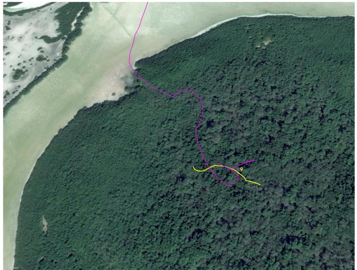
Figura 18. Derecha: Orientación del transecto de ERT en OJO de agua. En morado se muestra trayectoria seguida en alijo. Marcador amarillo representa la posición del ojo de agua y línea amarilla disposición final del transecto medida con cinta y brújula. Izquierda: Ampliación de la orientación del transecto.
