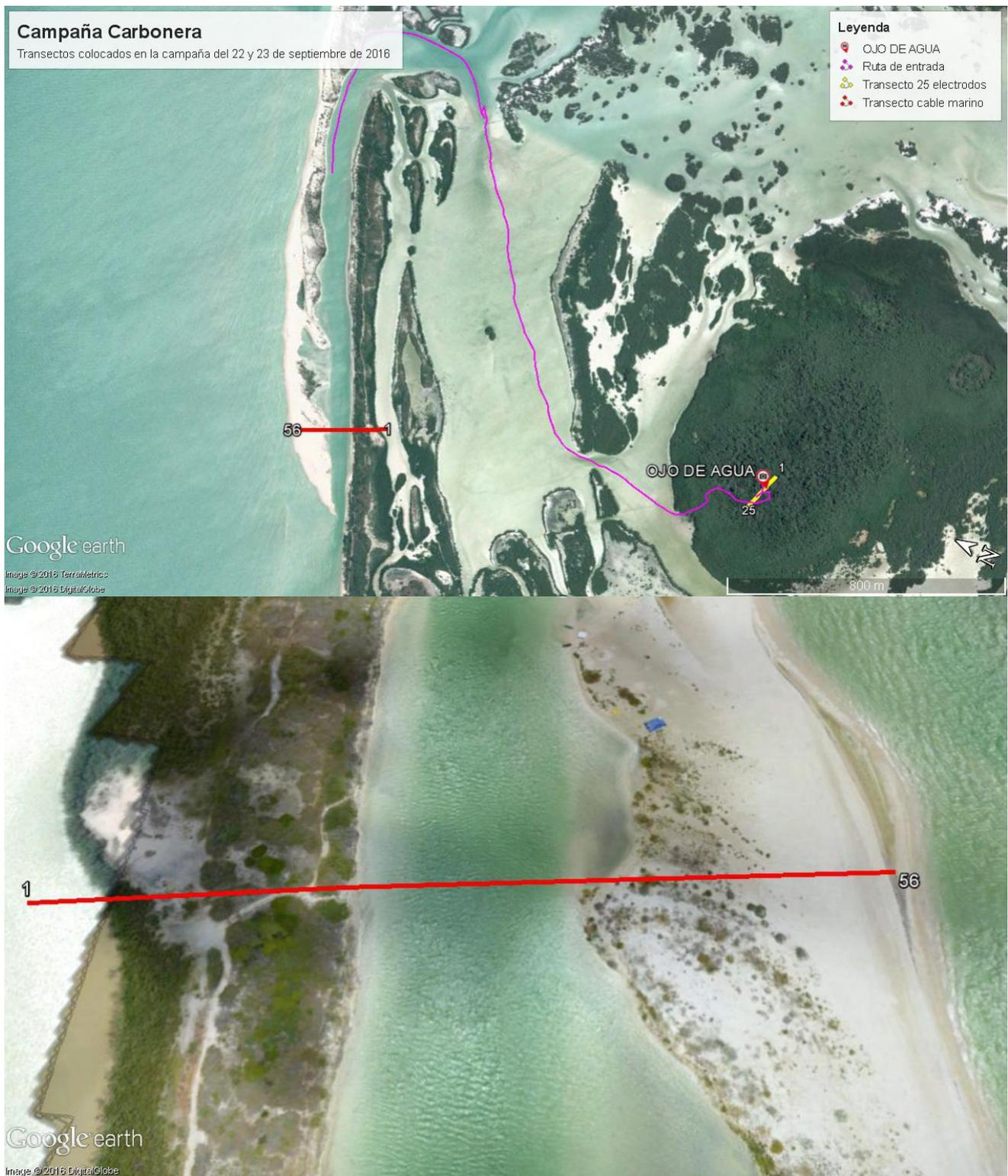
Figura 9. Arriba: Localización de los puntos de adquisición de las tomografías de resistividad eléctrica. En rojo se muestra el transecto T1 y en amarillo un bosquejo de T2. Abajo: Ampliación de la zona y colocación del transecto T1. La línea recta se sobrepuso a imágenes de dron de julio de 2016.
