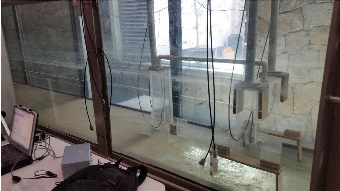
*Figura 4.2.2. . Configuración final del dispositivo OWC-MDS. El cual consta de 2 cámaras de aire y un conducto por el cual pasara el flujo de aire.*
